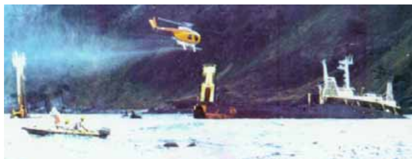
写真 1 4 ヘリコプター（ヒューズ 500D）による油処理剤散布 農薬散布器により直接散布、一度に 230 ㍓散布できる。
