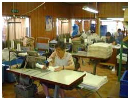
授産施設での杉樹皮製油吸着材の製造（縫製）
