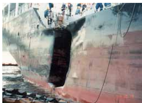
写真2 TO丸の衝突痕 相手船船首部が
