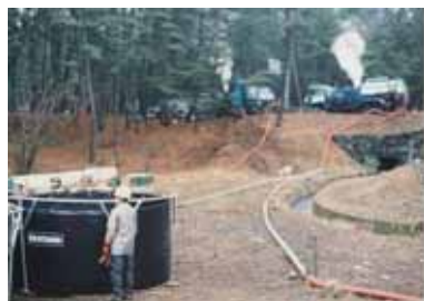
写真10 強力吸引車 竜巻流で吸引するため、高低差20m,水平100m程度は容易に油を回収
