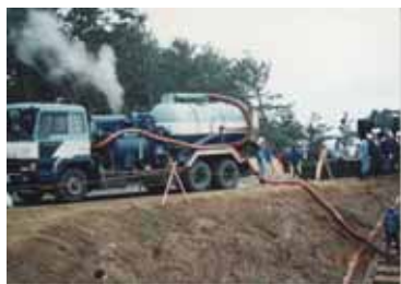
写真10 強力吸引車 竜巻流で吸引するため、高低差20m,水平100m程度は容易に油を回収
