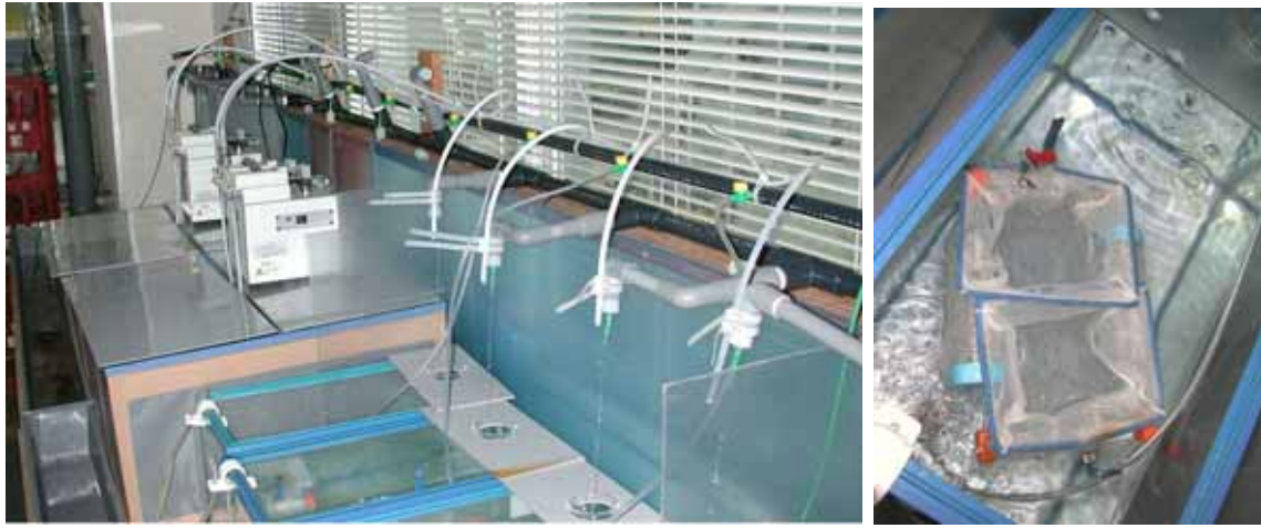
図3 流水式試験装置(右)及びネットに収容したマミチヨグふ化仔魚(左)
