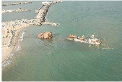
写真15. 船首部のみの牽引作業
