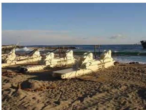
写真12. 大型油圧牽引機
