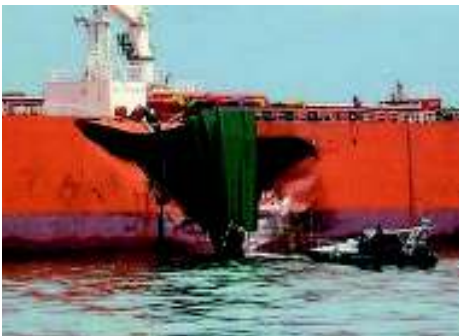
貨物船との衝突で船体側面にできた大きな穴、この事故で2,500トンの油が流出
