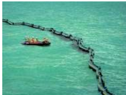
流出した油の囲い込みに使われる石油連盟のオイルフェンス
