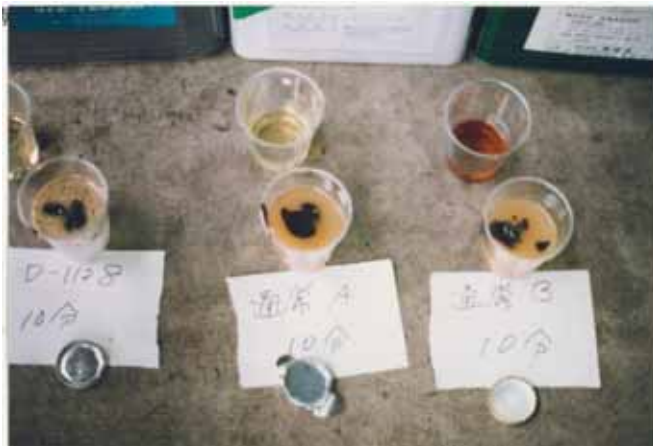
事前テスト 現場のサンプル油を3種類の油処理剤 で効果テスト実施 海水9、気温3 (ナホトカ号事故。 現在はテスト専用のキットがある)
